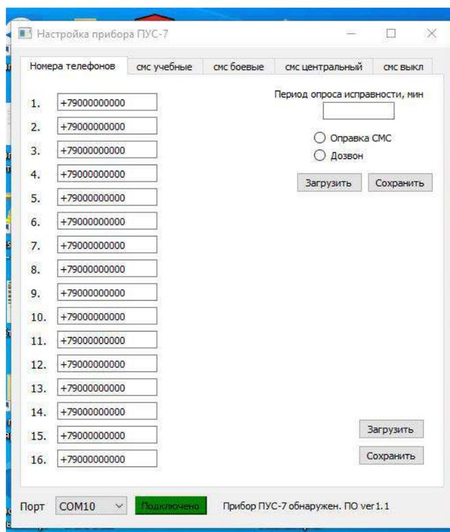
Появится сообщение **Прибор ПУС-7 обнаружен. ПО ver 1.1**. Если ранее прибор программировался, после нажатия кнопки **Загрузить**, в правом нижнем углу, появится список записанных в память прибора телефонов. После редактирования номеров телефонов, следует нажать **Сохранить** (в нижнем правом углу)
